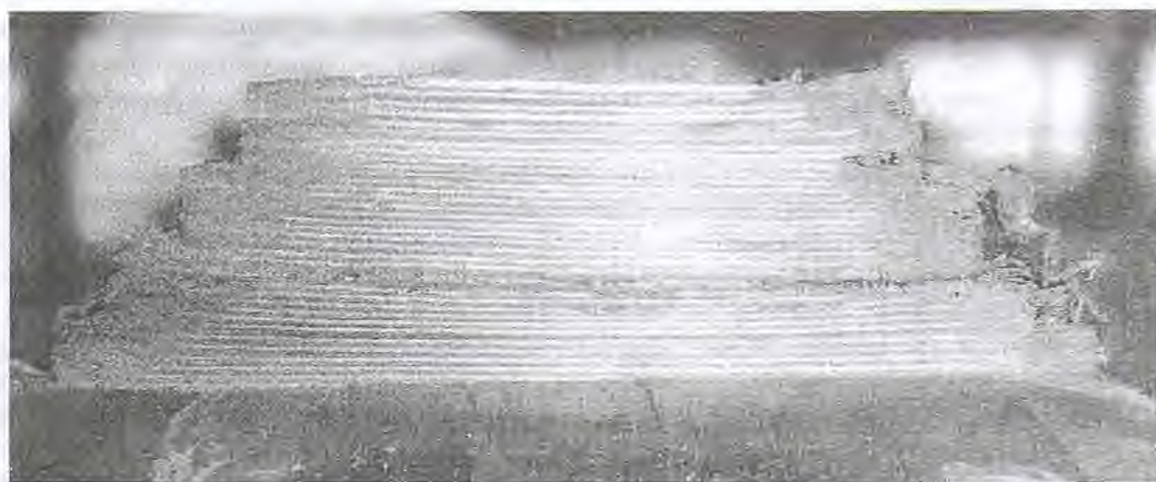
Рис. 2. Первичная обмотка верхнего каскада ТН типа НКФ-110 (разрез)
