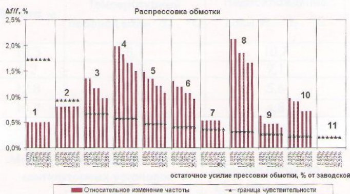
Рис. 1. Относительное изменение частот резонансов ПФ при распрессовке
