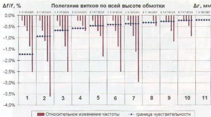
Рис. 2. Относительное изменение частот резонансов ПФ при "полегании" по всей высоте обмотки.
