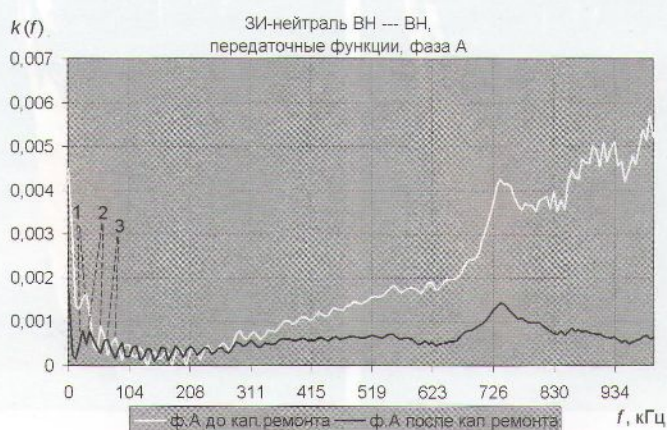
Рис. 3. ПФ обмоток ВН трансформатора ТМН-2500/110 ЧТЗ зав. №1665 до и после подпрессовки обмоток
